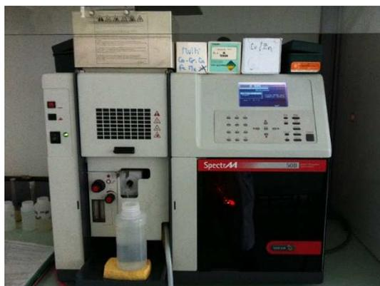
Figure 16 : Spectromètre d'absorption atomique.
