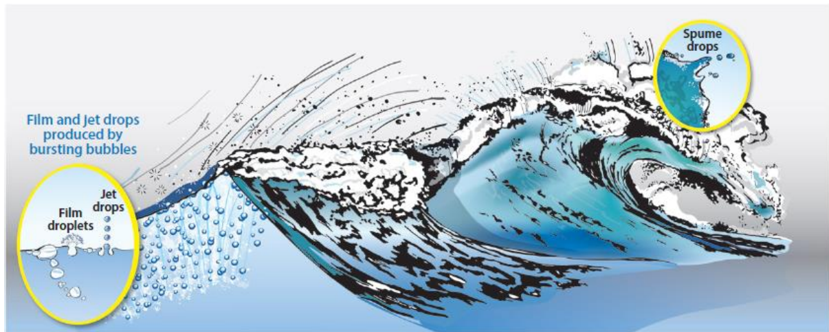
Figure 35. Représentation schématique des mécanismes de production de gouttelettes : l'éclatement de bulles en surface et l'arrachement par le vent. Tiré de Veron et al. (2015) et adapté de Andreas et al. (1995) .
