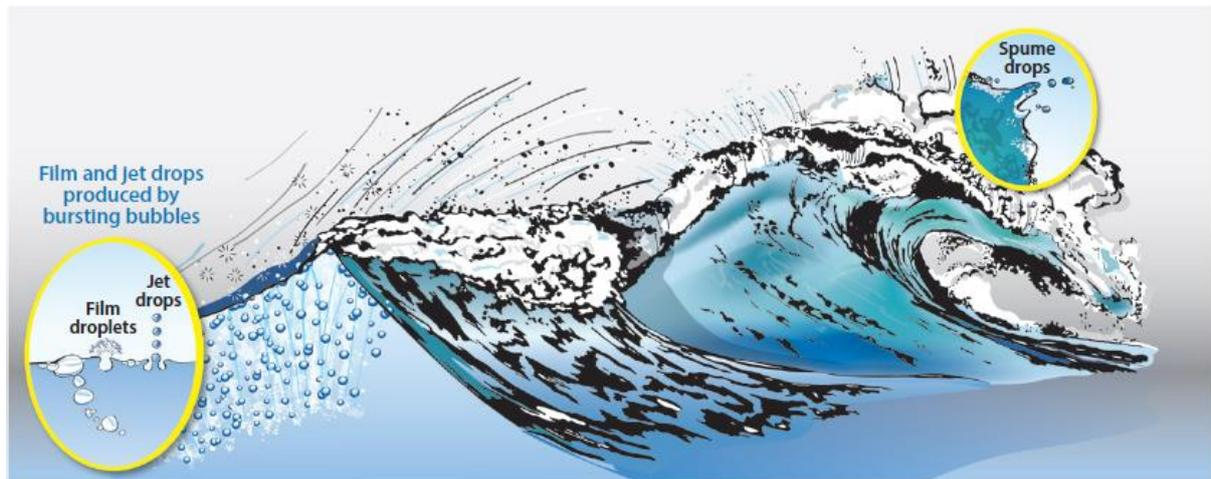
Figure 35. Représentation schématique des mécanismes de production de gouttelettes : l'éclatement de bulles en surface et l'arrachement par le vent. Tiré de [Veron et al. \(2015\)](#) et adapté de [Andreas et al. \(1995\)](#).
