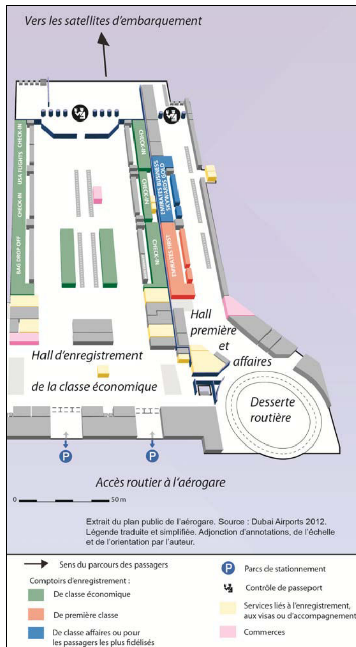
Figure 20 – Extrait du plan du terminal 3 de Dubaï : une desserte routière et un hall d'enregistrement à l'écart pour les passagers les plus rémunérateurs.
