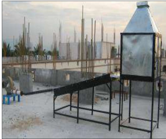
Figure I. 9: La configuration expérimentale du séchoir solaire
