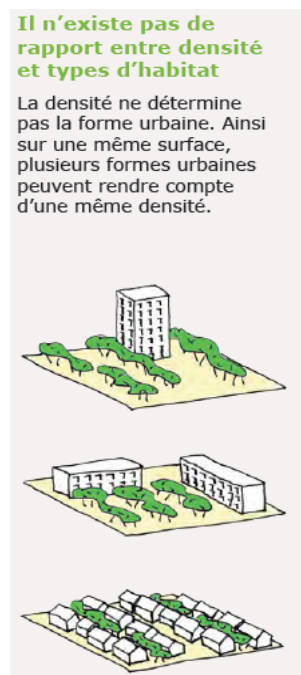
Figure 51 différents types d'habitats pour un même COS (source Fiche « l'essentiel de la densité urbaine » CERTU)
