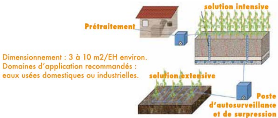
Figure 73 Synoptique de la solution mixte de traitement par phytoremédiation proposée par la société PHYTOREM (extrait plaquette PHYTOREM)
