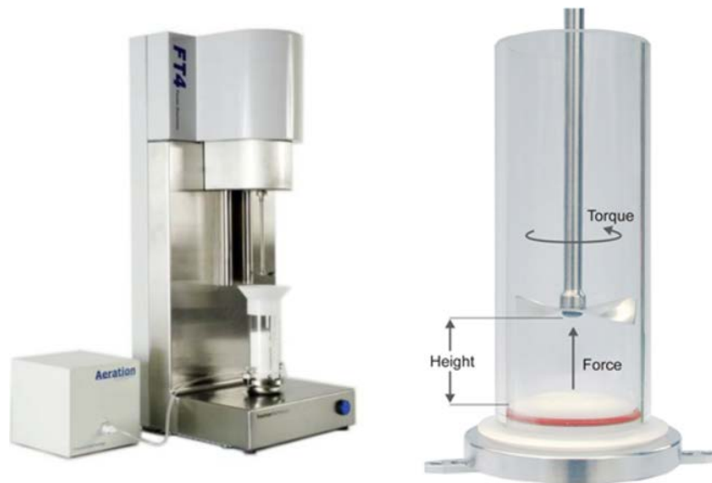
Figure II-5 : Principe du rhéomètre à poudres FT4.
