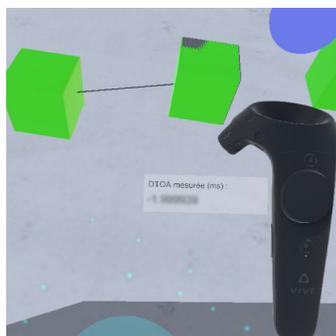
FIGURE 6.16 – Exemple de mesure de la différence de temps entre deux impulsions. Après une sélection maintenue d'une impulsion à une autre, un panneau contenant la différence de temps entre ces deux impulsions apparaît à côté de la manette.
