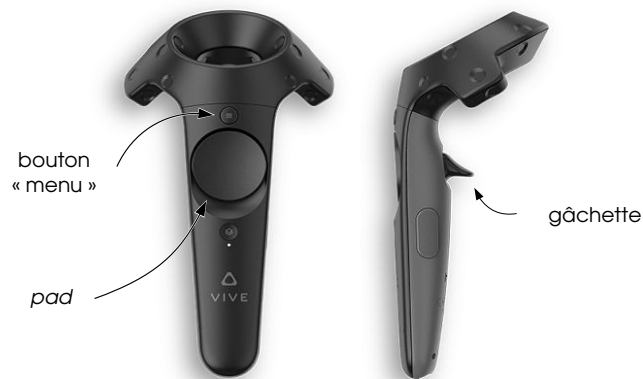
FIGURE 6.9 – Schéma représentant les actionneurs des manettes de l'HTC Vive utilisées pour HeloVis
