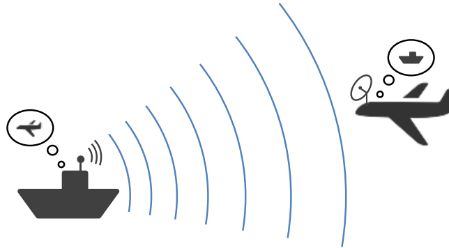
FIGURE 2.1 – Usage du radar de manière active pour la détection d'un avion par un bateau et usage du radar de manière passive pour l'identification du bateau par l'avion
