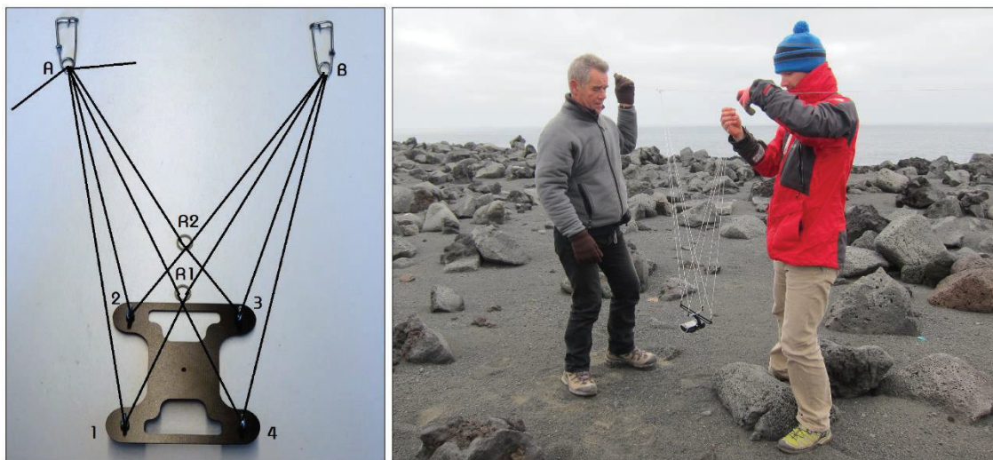
Figure 1-45. Présentation du picavet (à gauche, source : www.kapshop.com ), et exemple de mise en place sur le terrain (à droite).
