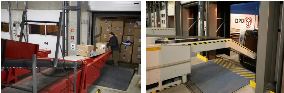
Figure 59 : Prolongement des convoyeurs automatiques jusqu'aux véhicules de traction (gauche) et de tournée (droite) dans les agences DPD de Erfstadt (Allemagne) et Oldbury (Grande-Bretagne)
