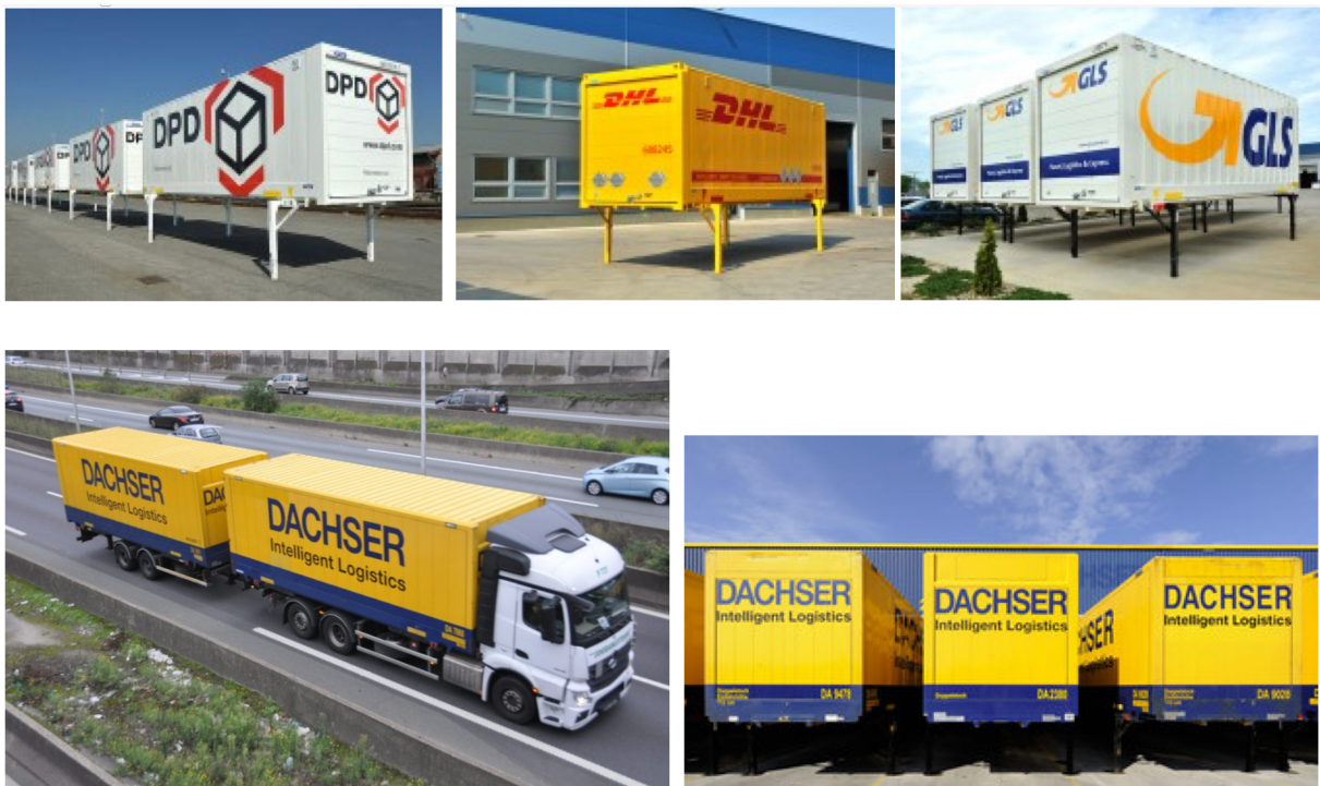
Figure 55 : Exemples de caisses mobiles stockées (en haut), chargées (en bas à gauche) ou à quai (en bas à droite)
