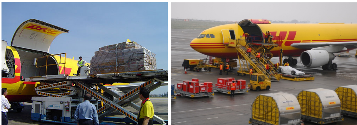
Figure 52 : Envois groupés sur des palettes dédiées au transport aérien (à gauche) ou dans des « igloos » (à droite) pour les tractions aériennes
