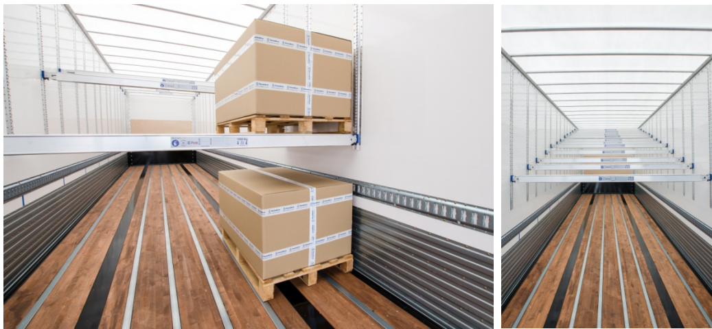
Figure 53 : Exemple de semi-remorque à double plancher pour les tractions de messagerie palettisée
