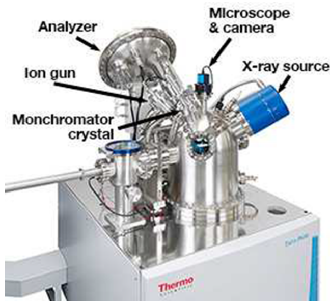
FIGURE 2.17 – Dispositif XPS Theta300 utilisé (source Thermo Fisher)
