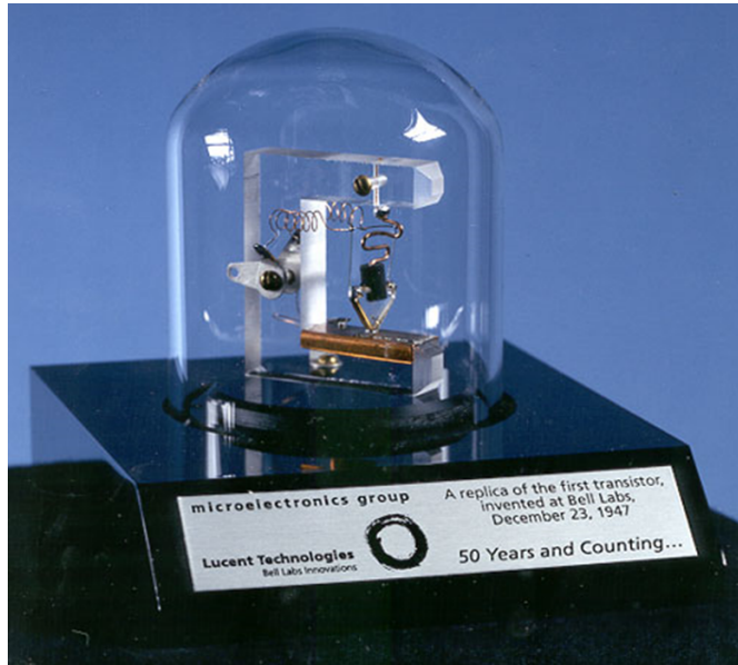
FIGURE 1.2 – Réplique du transistor bipolaire créé en 1948 par J. Bardeen, W.H. Brattain et W. Shockley [source : Wikipédia]
