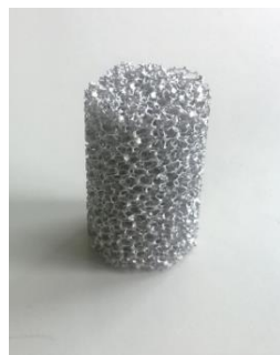
Figure V.5 : Mousse métallique en aluminium utilisée.
