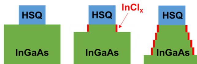
Figure III.22 – Schéma montrant l’élargissement des motifs d’InGaAs par la présence de produits de gravure non volatils sur les flancs
