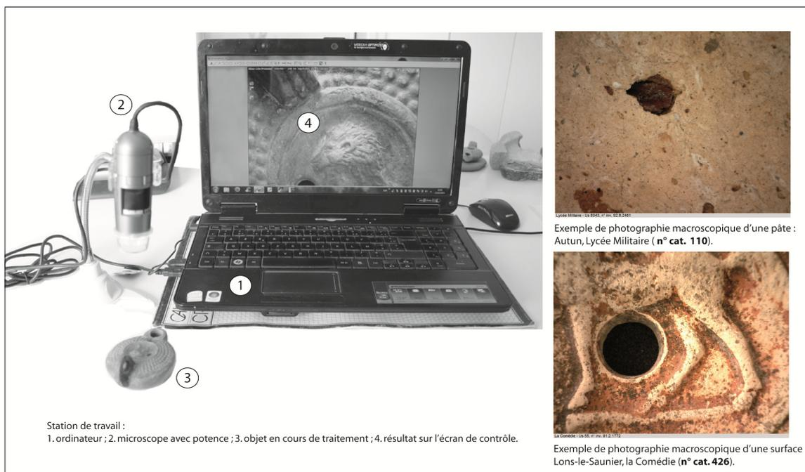
Figure 31 – Exemple d'application d'un microscope digital en lychnologie (© C. Malagoli 2015).
