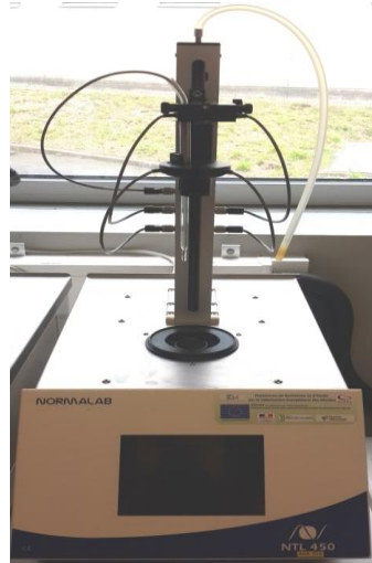
Figure 2. 20 : Appareil de mesure de la température limite de filtrabilité
