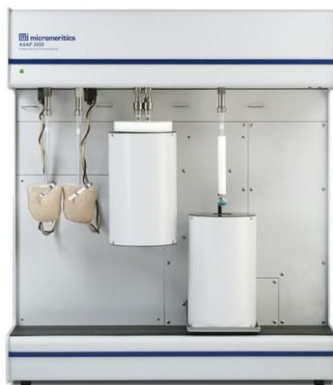
Figure 2. 21 : appareil utilisé pour l'adsorption/désorption de diazote
