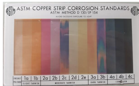
Figure 2. 14 : Normes de corrosion de la bande de cuivre
