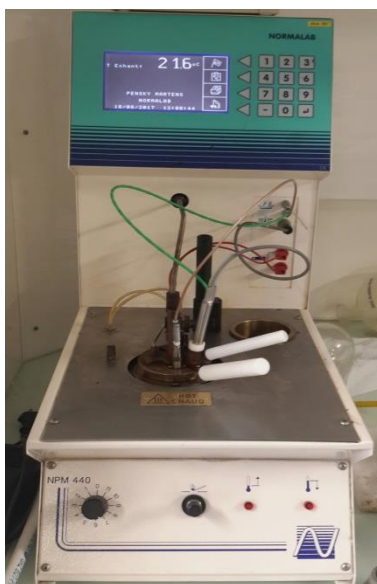
Figure 2. 19 : Appareil de mesure du point d'éclair
