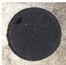
Figure V.22 : Photographie de la mousse PSZB3,75/PMMA25 \mu = 20/80 - 120°C - 5T, après pyrolyse.
