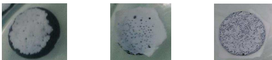
Figure VII.1 : Photographies de supports présentant une plaque épaisse de \text{TiO}_2 sur l'une de leurs faces, masquant les pores.
