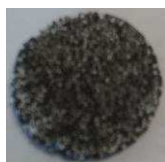
Figure VII.8 : Photographie de la mousse PCSB/PMMA300 \mu = 20/80 recouverte de E50.
