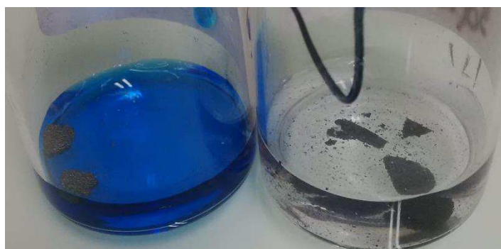
Figure VII.9 : Photographie de solutions de test photo-catalytique : à gauche, une mousse vierge, à droite, la mousse dans laquelle nous avons intégré la formulation E50 ; le bleu de méthylène n'est plus en solution, formant des particules visibles à l'œil nu.
