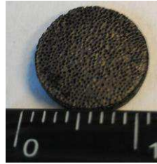
Figure V.29 : Photographie d'une mousse céramique de SiBCN : PSZB3,75/PMMA300 \mu = 30/70 - 120°C - 1T.
