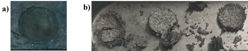
Figure V.21 : Photographie de mousses déformées issues du PMEBZ : a) Mousse concave et b) Mousses explosées.
