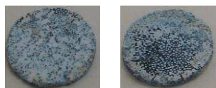
Figure VII.18 : Photographies des deux faces d'un photo-catalyseur supporté (enduction avec une suspension de P25 de Degussa d'une mousse PSZB3,75/PMMA300 \mu = 20/80).
