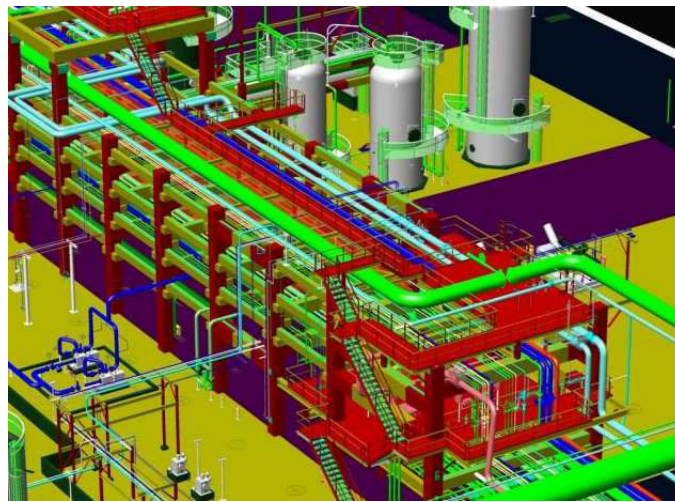
FIGURE 2.3 – Routage de pipe dans une installation industrielle
