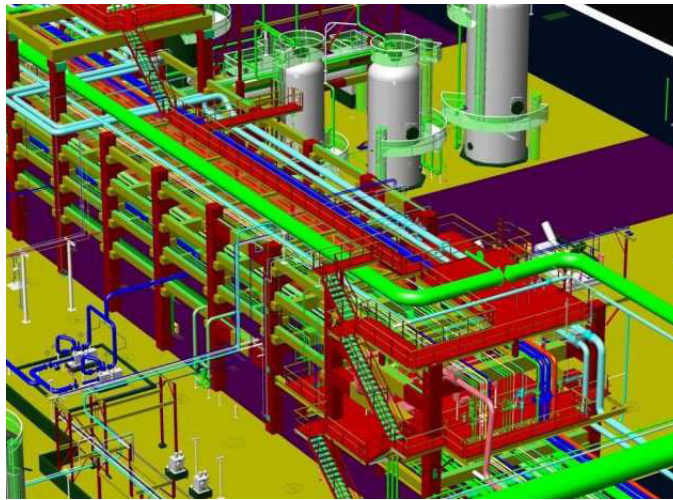
FIGURE 2.3 – Routage de pipe dans une installation industrielle
