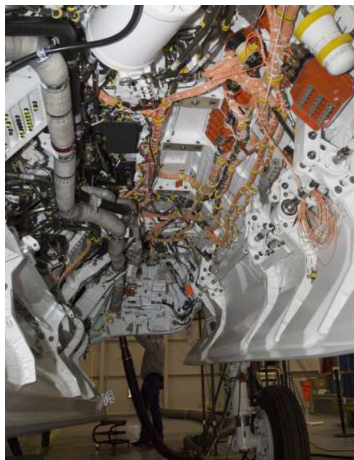
FIGURE 2.11 – Exemple de routage réel d'une soute d'armement d'un F-35 Joint Strick Fighter
