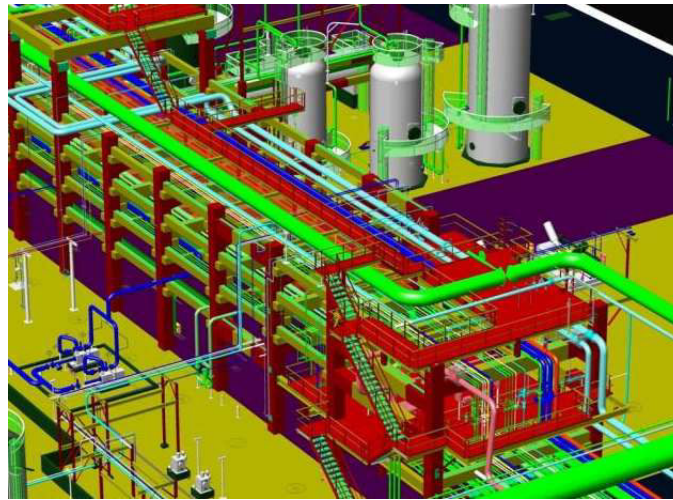
FIGURE 2.3 – Routage de pipe dans une installation industrielle
