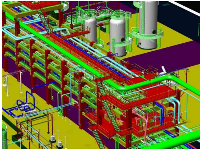
FIGURE 2.3 – Routage de pipe dans une installation industrielle
