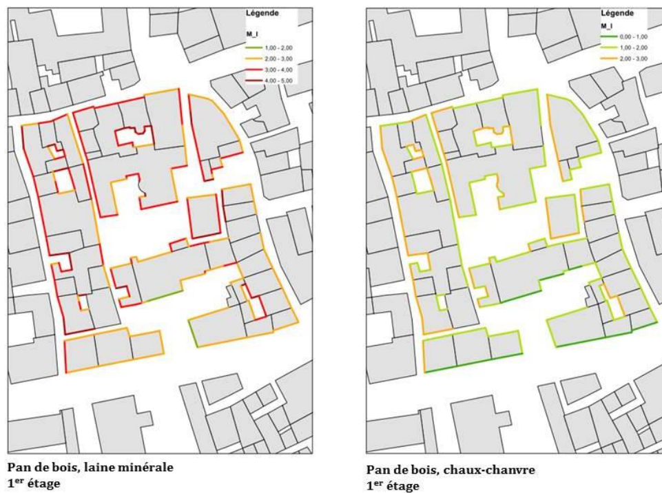
Figure 95: Cartographie des risques à l'interface pour la typologie pan de bois
