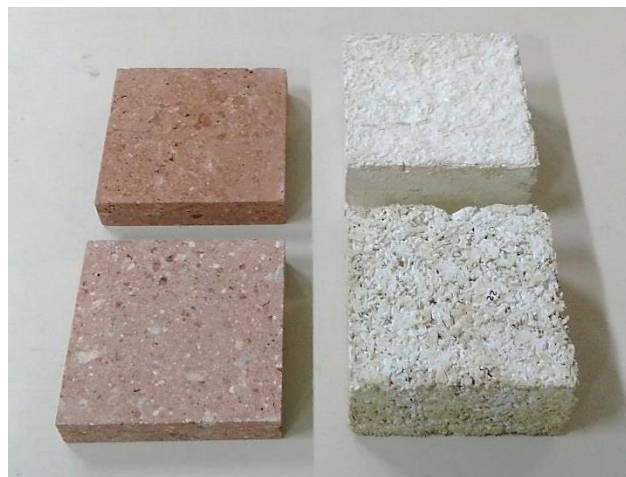
Figure 14 : Brique 18 e (bas gauche), brique 16 e (haut gauche), mélange chaux-chanvre CC1 (bas droite), mélange chaux-chanvre CC2 (bas droite)
