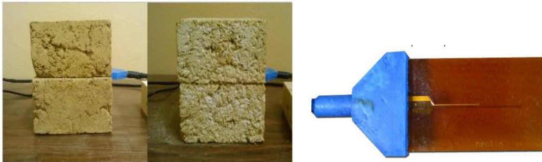
Figure 18: Méthode du fil chaud et sonde utilisée (produit par Neotim FP2C)
