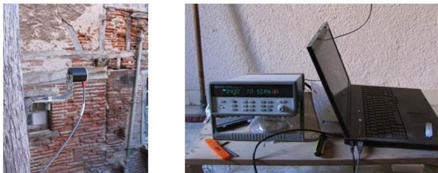
Figure 31: Pyranomètre (gauche) et centrale d'acquisition Agilent (droite)
