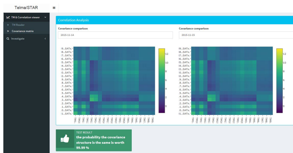
FIGURE 1.27 – Application STAR pour l’analyse des télémétries - onglet pour visualiser et comparer la matrice de covariance de deux jours de télémétries.
