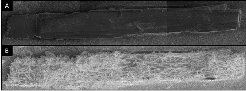
FIGURE 2.6 – Clichés MEB représentant un échantillon de  $\text{Rb}_2\text{Ti}_2\text{O}_5$  sur toute sa longueur. La figure a représente l'échantillon vierge et la figure b après une exposition de 72 heures à l'air ambiant. Clichés réalisés par Armel Descamp-Mendines (LPEM) et Rémi Federicci (LPEM)
