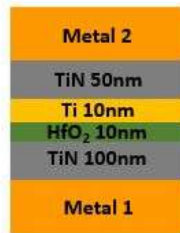
Figure II.11 : Représentation schématique de la structure MIM TiN/HfO 2 /Ti/TiN étudiée dans cette partie.
