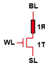
Figure IV.4 Schématisation d'un dispositif 1T1R et des connections associées.
