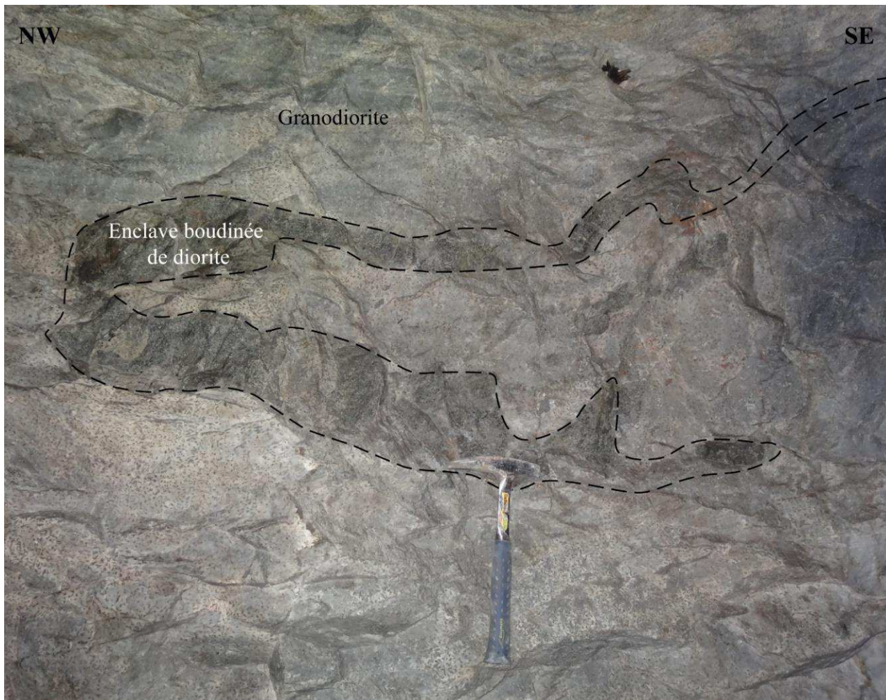
Photo 21 : Enclave boudinée de diorite (roche magmatique sombre) au sein de la granodiorite de la Fourque dans la recoupe R1 du niveau 1230.
