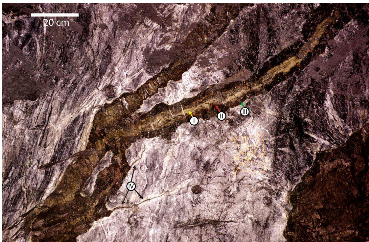
Photo 4 : Zonation de type A observée dans les skarns développés aux dépens des marbres inférieurs graphiteux ; (I) Endoskarn, (II) Exoskarn – zone à grossulaire, (III) Exoskarn – zone à hédénbergite, (IV) Marbre graphiteux lessivé (modifié d'après Derré et al., 2014)
