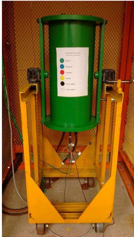
Figure A. 1: Photo d'un autoclave à chauffage interne.
