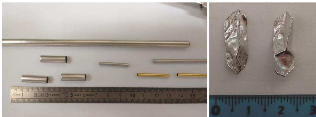
Figure A. 4: Tubes en métal noble (Pt en gris et Au en jaune), utilisés pour la formation des capsules. Capsules en sortie d'expérience soudées à l'aide d'une soudure triple.
