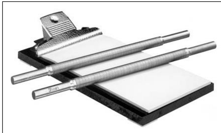
Figure II.4. Enduseur tire film « bar coater »
