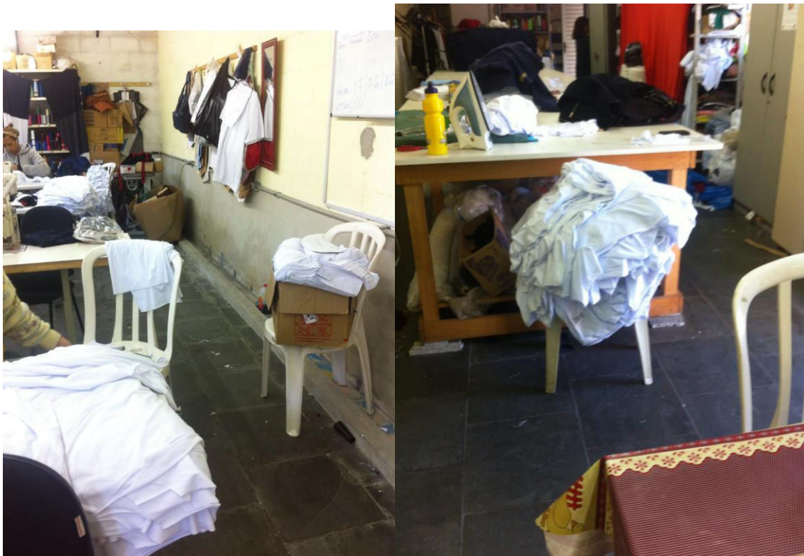
Figure 41 : Exemples de photographies prises par les étudiantes de l'équipe pour mettre en évidence les défauts d'organisation du groupe TECO. Selon elles, le principal problème repose sur l'usage de chaises et de tables, et non d'étagères, pour disposer les pièces effectuées par les couturières au fur et à mesure de la production.
