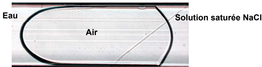
Figure 55 : Angles de contact entre l'air et l'eau pure (proche de 0^\circ ), et entre l'air et une solution saturée en NaCl (proche de 60^\circ ).
