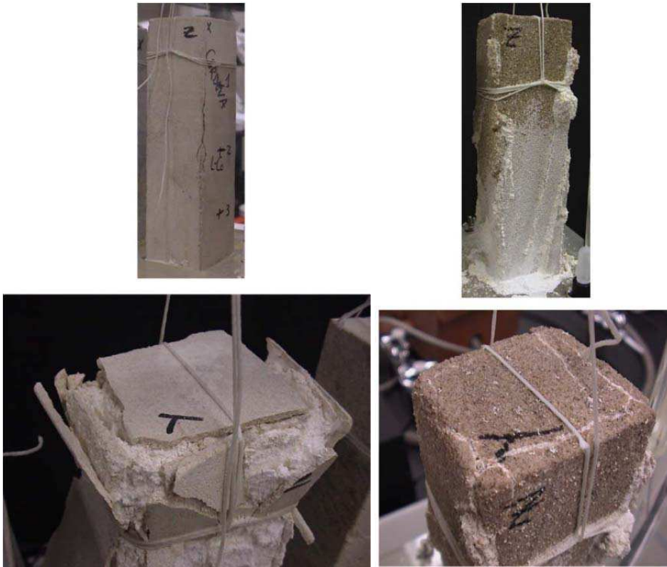
Figure 9 : Degré d'altération en fonction de la porosité, après trempage dans une solution de \text{Na}_2\text{SO}_4 (14 wt %, 39% RH). A gauche, un bloc de calcaire à porosité fine et à droite, un bloc de grès macroporeux. D'après Scherer, 2004
