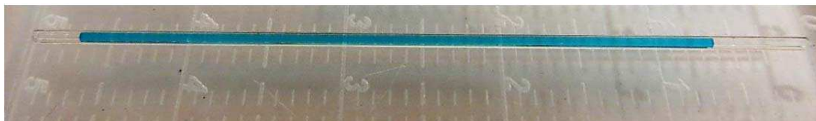
Figure 12 : Capillaire cylindrique (200 \mu\text{m} de diamètre) rempli avec une solution colorée au bleu brillant
