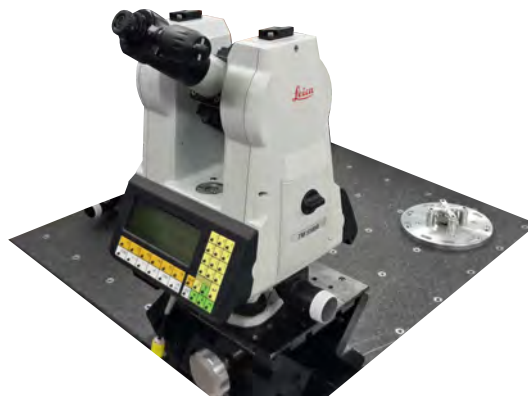
Figure 4.26 – Photos des théodolites utilisés pour mesurer les relations angulaires entre chaque miroir.
