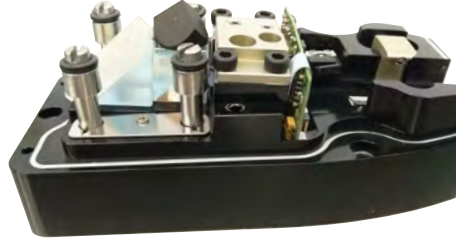
Figure 8.25 – Les différents éléments à l'intérieur de la tête interférométrique.
