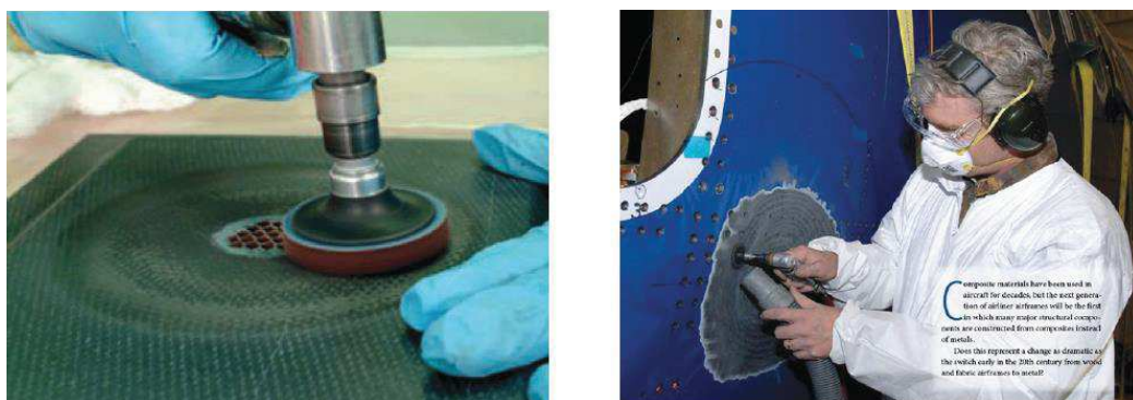
Figure 17 : Différentes configurations d'usinage manuel [Werfelman, 2007] [www.abaris.com]
