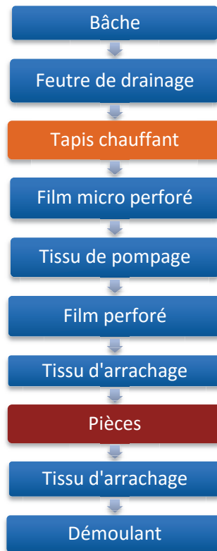
Figure 39 : Etapes de la superposition des tissus pour la cuisson du film adhésif
