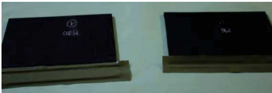
Figure 40 : Mise en place du film adhésif sur les demi-plaques 20 mm (gauche) et 6 mm (droite)
