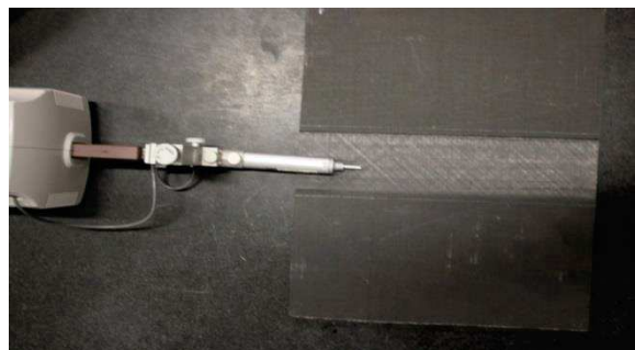
Figure 46 : Mesure de la rugosité sur la surface usinée dans deux directions avec 45^\circ (gauche) et 90^\circ (droite)
