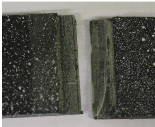
Figure 52 : Rupture cohésive du joint de colle
