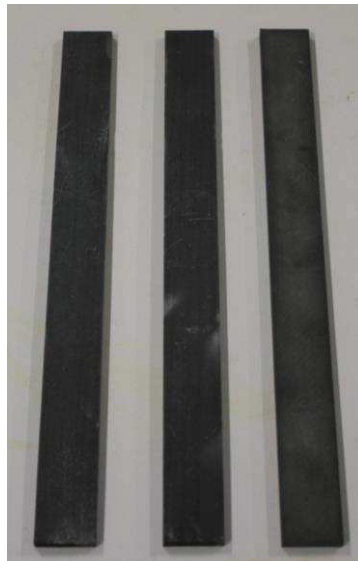
Figure 127 : Eprouvettes provenant des chutes de détournage
