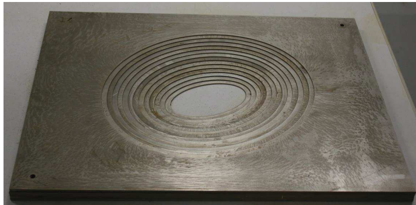
Figure 125 : Masques pour usiner la plaque composite pli par pli
