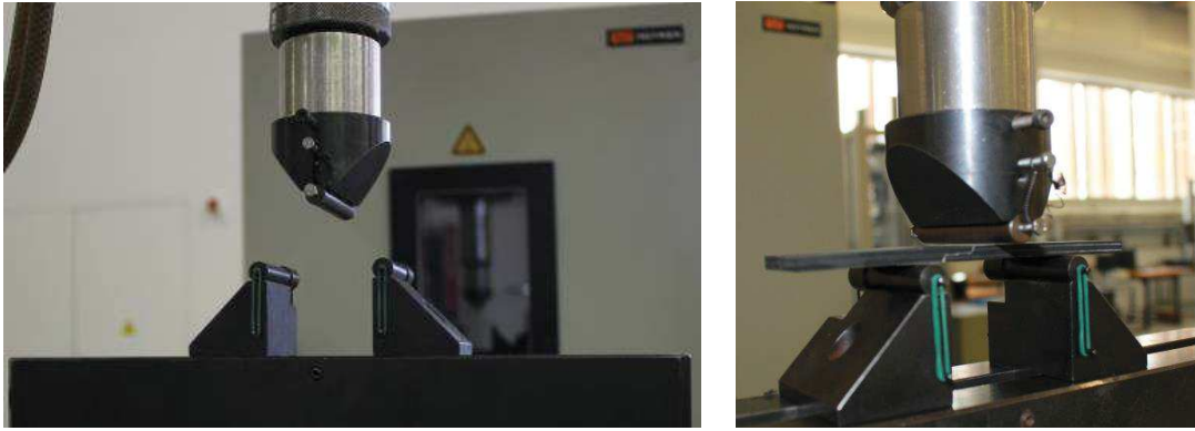
Figure 57 : Disposition du montage de l'essai de flexion trois points
