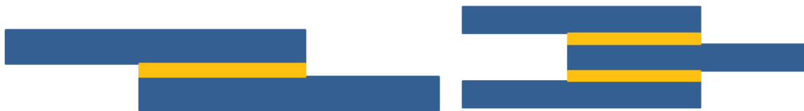
Figure 13 : Types de patches externes, single lap (gauche) et double lap (droite) (échelle non représentative)
