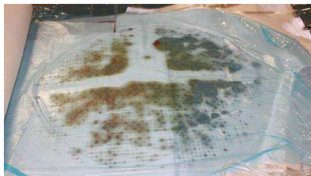
Figure 141 : Présence de résine dans le tissu de pompage
