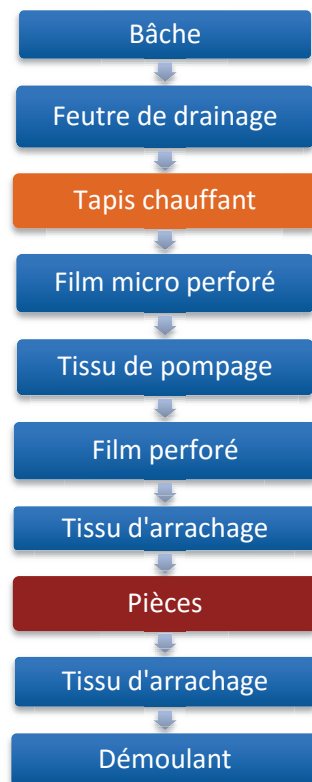
Figure 39 : Etapes de la superposition des tissus pour la cuisson du film adhésif
