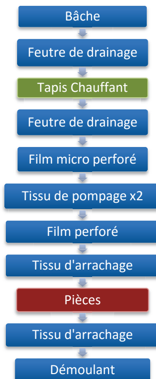
Figure 140 : Séquence de placement des produits d'environnement pour la cuisson d'un matériau composite
