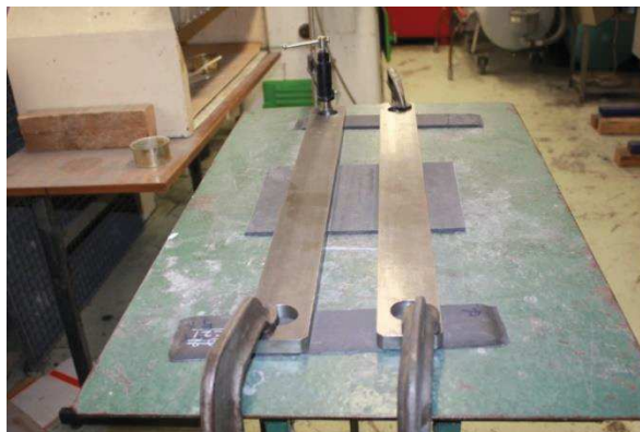
Figure 35 : Mise en place des guides et de la plaque pour l'usinage
