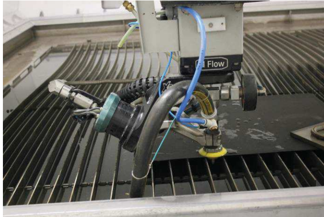
Figure 124 : Jet d'eau abrasif avec la technologie Ultra Pierce
