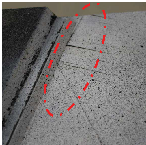
Figure 158 : Présence de délaminages et ruptures de fibre en toute fin d'essai
