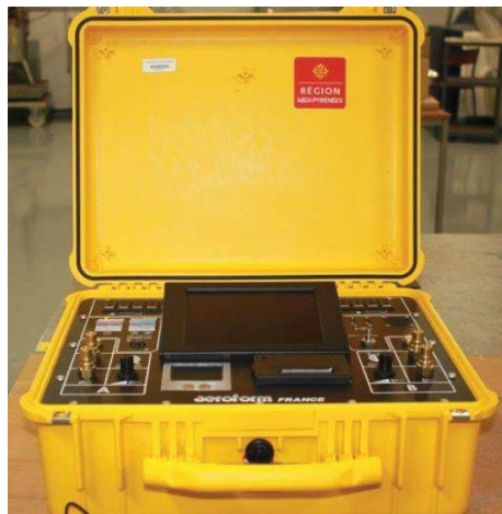
Figure 38 : Valise de polymérisation servant à la cuisson du film adhésif
