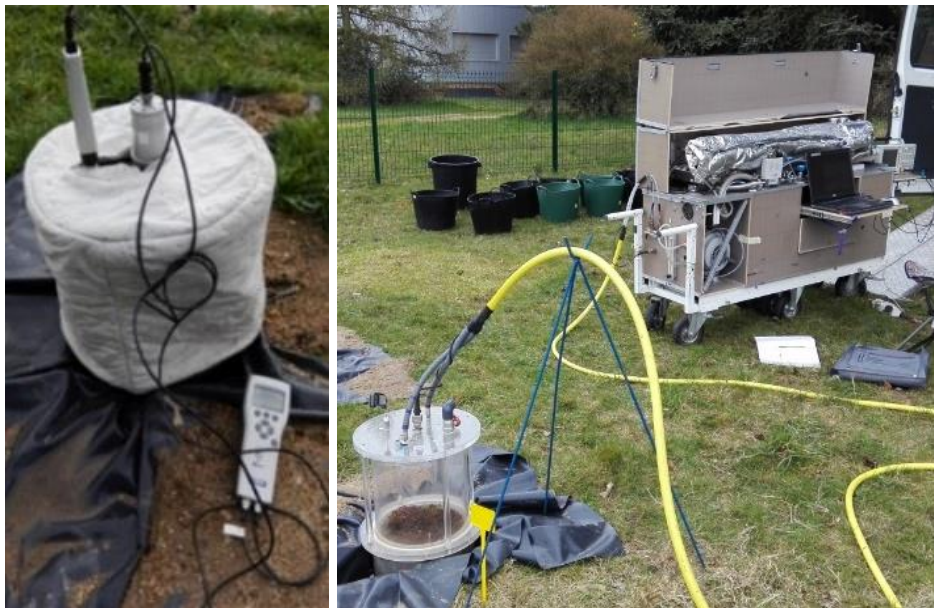
Figure II-6 Mesures des flux de GES en chambre fermée avec la sonde Vaisala (à gauche) et le SPIRIT (à droite).
