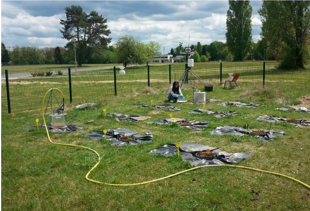
Figure II-4 Dispositif expérimental des mésocosmes et mesures des flux de GES et station météorologique
