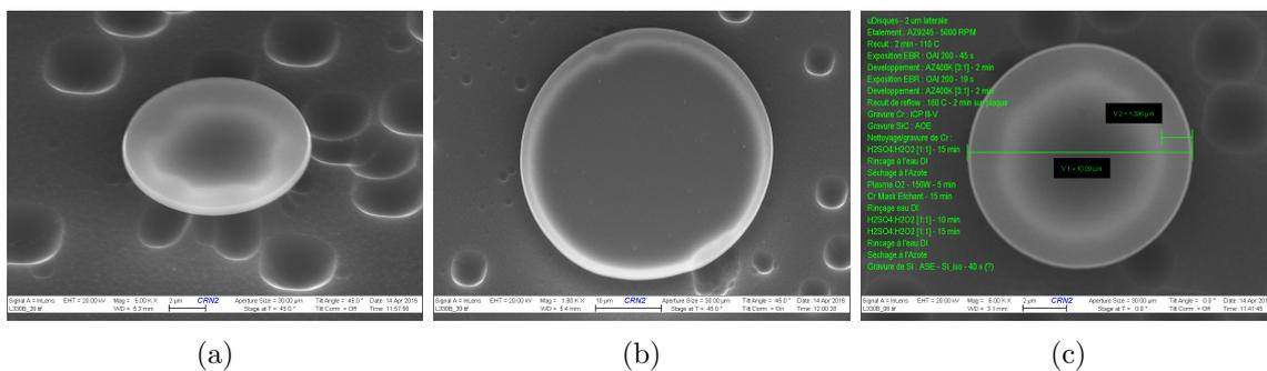
FIGURE 2.29 – Observation au microscope électronique à balayage de micro-disques de SiC. (a) Disque de 10  $\mu\text{m}$  de diamètre avec un pilier de 7.2  $\mu\text{m}$  (b) disque de 40  $\mu\text{m}$  avec un pilier de 37  $\mu\text{m}$  (c) disque de 10  $\mu\text{m}$  avec un pilier de 7.2  $\mu\text{m}$  avec les barres de mesure
