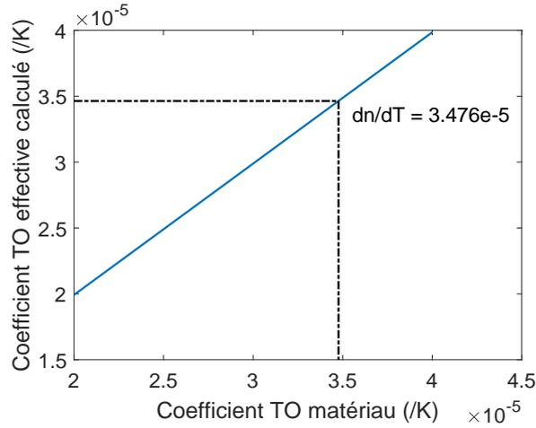
FIGURE 3.34 – Coefficient thermo-optique effectif  $\frac{\partial n_{eff}}{\partial T}$  calculé à partir du mode solveur pour le mode TE<sub>40</sub> en fonction du coefficient thermo-optique du matériau. La méthode 1 utilise uniquement l'indice du matériau calculé à partir de l'équation (3.5). La méthode 2 utilise l'approche que nous venons de développer avec l'analyse par mode solveur.
