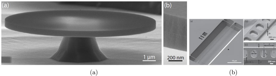
FIGURE 2.8 – Image de gauche : (a) Image SEM d'un micro-disque d'épaisseur 570 nm et de rayon 6  $\mu\text{m}$ . (b) SEM image du bord du disque. Crédit [28]. Image de de droite : (a) Vue globale d'une cavité à cristal photonique suspendue en SiC amorphe (b) zoom de la même image (c) vue du dessus avec les dimensions :  $w = 1.26a$ ,  $h_x = 0.63a$ , et  $h_y = 0.85a$  pour  $a$  compris entre 500 nm et 550 nm. [288]
