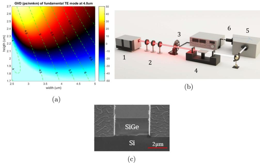
FIGURE 4.5 – (a) Dispersion de la vitesse de groupe pour le mode TE dans un guide ruban à une longueur d'onde de 4  $\mu\text{m}$ . (b) Montage expérimental (1) OPA accordable, (2) Lentilles et polariseurs optiques, (3) chopper connecté au lock-in amplifieur, (4) échantillons et lentilles en chalcogénure, (5) analyseur de spectre (OSA), et (6) photodétecteur MCT. (c) Image MEB d'un guide de SiGe sur substrat de Si entouré d'air. [17]
