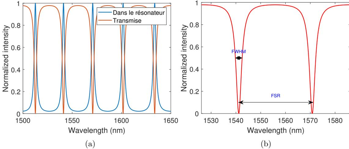
FIGURE 1.10 – (a) Profil de l'intensité transmise (rouge) et dans le résonateur (bleu) pour un disque de  $15 \mu\text{m}$  de diamètre en SiC d'indice  $n_{SiC} = 2.6$  (b) Agrandissement de deux résonances pour illustrer le FWHM et le FSR.
