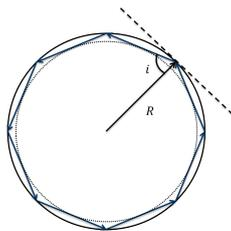
FIGURE 1.2 – Principe de la réflexion totale interne. L’angle  $i$  correspond à l’angle avec la normale du cercle,  $r$  étant le rayon. Le cercle intérieur en pointillé illustre le fait que la lumière reste principalement piégée près du bord. Une approche simple basée sur l’optique géométrique permet de saisir le principe des modes galerie à l’intérieur de résonateur circulaire, les rayons possédant un angle supérieur à l’angle critique restent piégés dans le disque.
