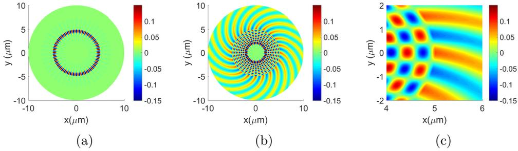
FIGURE 1.5 – Profil du champ électrique  $E_z$  du mode TM pour un disque de  $5 \mu\text{m}$  à une longueur d’onde de  $\lambda = 1.55 \mu\text{m}$  et l’indice de réfraction du carbure de silicium  $n_{SiC} = 2.6 \mu\text{m}$  (a) pour  $m = 46$  (b)  $m = 20$  (c)  $m = 20$  agrandi sur le bord du disque.
