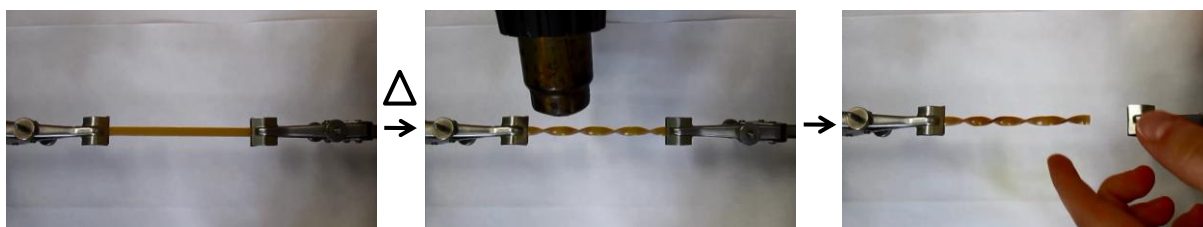
Figure 80 – Les composites GLYMO-Zeosil peuvent être remis en forme en quelques minutes par chauffage local (200°C)
