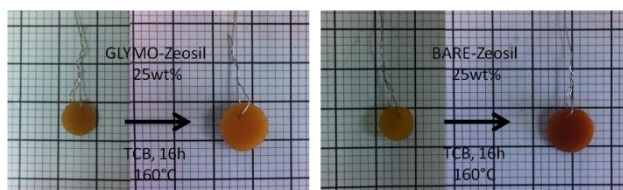
Figure 77 – Expériences de gonflement réalisées dans le TCB à 160°C pendant 16 h des composites BARE-Zeosil et GLYMO-Zeosil.
