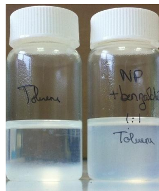
Figure 158 – Dispersions de silice fonctionnalisée amine en absence (gauche) et en présence (droite) de benzaldéhyde, photo prise 1min après arrêt de l'agitation
