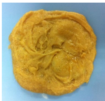
Figure 52 - Mélange avec silice Z1165MP ayant pris en masse après 10 min sous vide à 130°C
