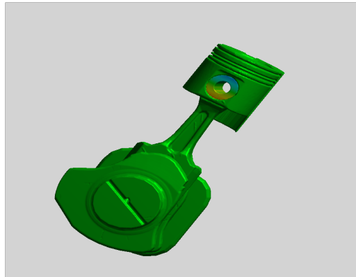
FIGURE 5.13 – Analyse statique sur le modèle piston
