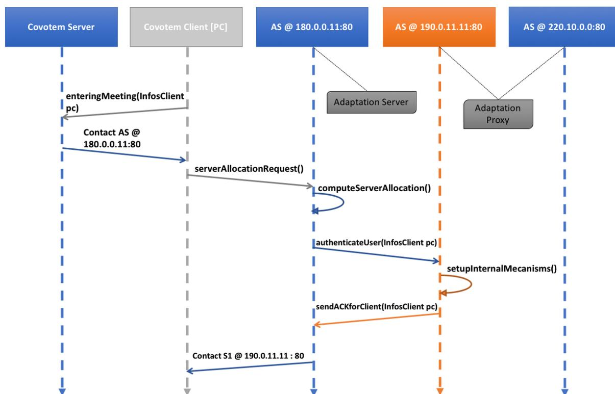
FIGURE 3.5 – Le diagramme de séquence de la connexion d'un client
