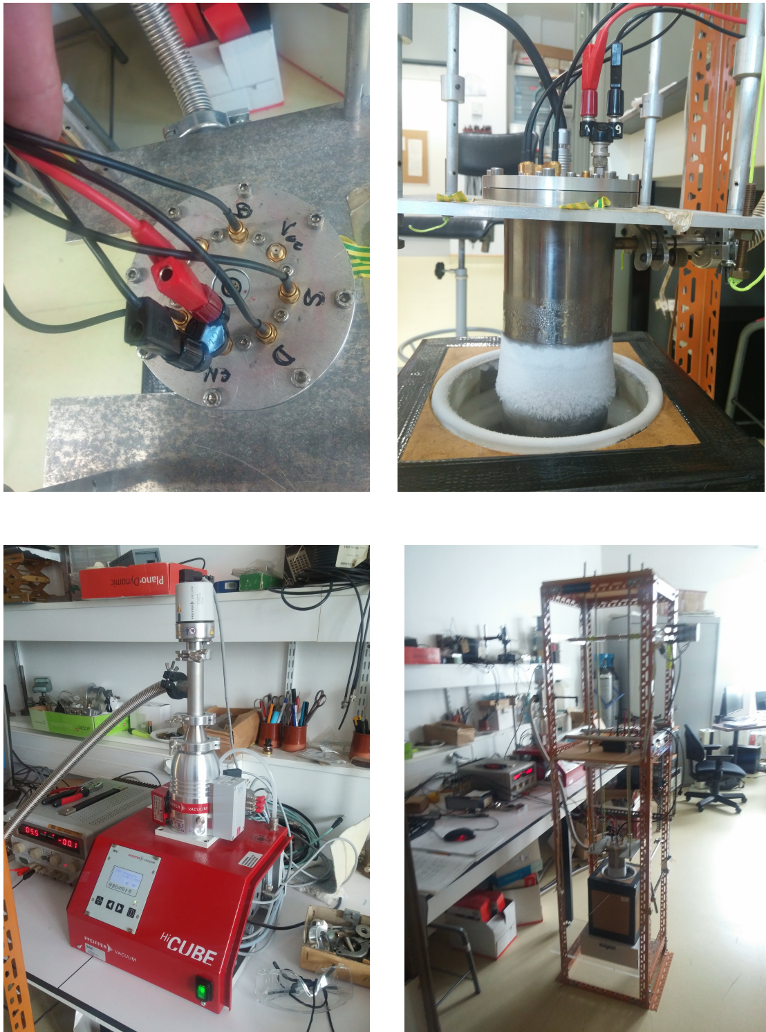
FIGURE 2.4: Photos du banc de caractérisation cryogénique [dans l'ordre] : les connecteurs SMA, le cryostat refroidi à 77K, la pompe à vide et le cadre de maintien avec son système de contrôle de température.
