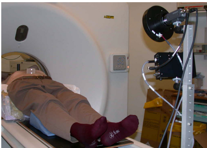
Fig. 5. Adaptation 4D du scanographe General Electric QX/i à quatre barrettes. La caméra RPM est fixée sur la table. Le marqueur RPM, visible sur l'abdomen du patient permet d'obtenir le signal. Ce signal permettra de trier a posteriori les images de la série 4D.
