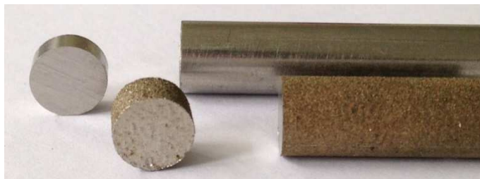
Figure 41 : Tiges et pastilles d'aciers inoxydables 316L : issues de fonderie (en haut) et de fabrication additive (en bas)
