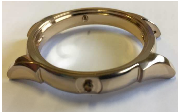
Figure 107 : Carrure de montre d'acier inoxydable 316L électropolie en milieu acide puis recouverte d'un revêtement électrolytique d'or
