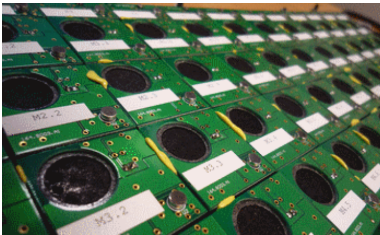
FIGURE 1: Exemple de peau active développée à l'institut FEMTO-ST constituée d'un réseau de haut-parleurs et microphones
