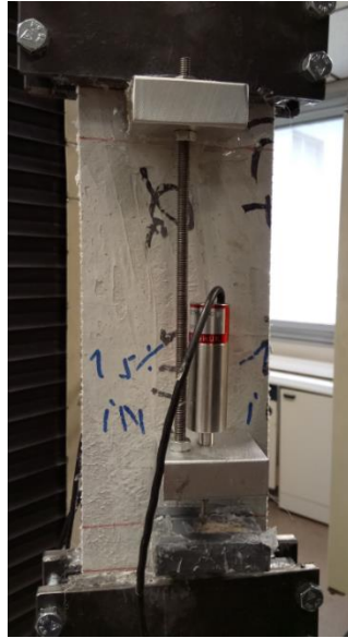
Figure III-42 : Instrumentation ( Capteur de déplacement LVDT)
