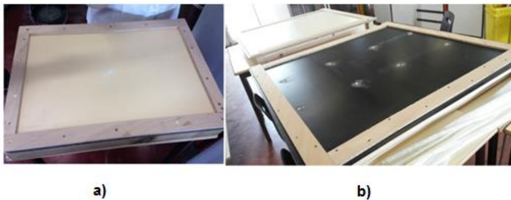
Figure III-3 : Moules utilisés pour la fabrication des composites TRC a) 600 mm x 400 mm x10mm b) 1010 mm x 1010 mm x 10 mm
