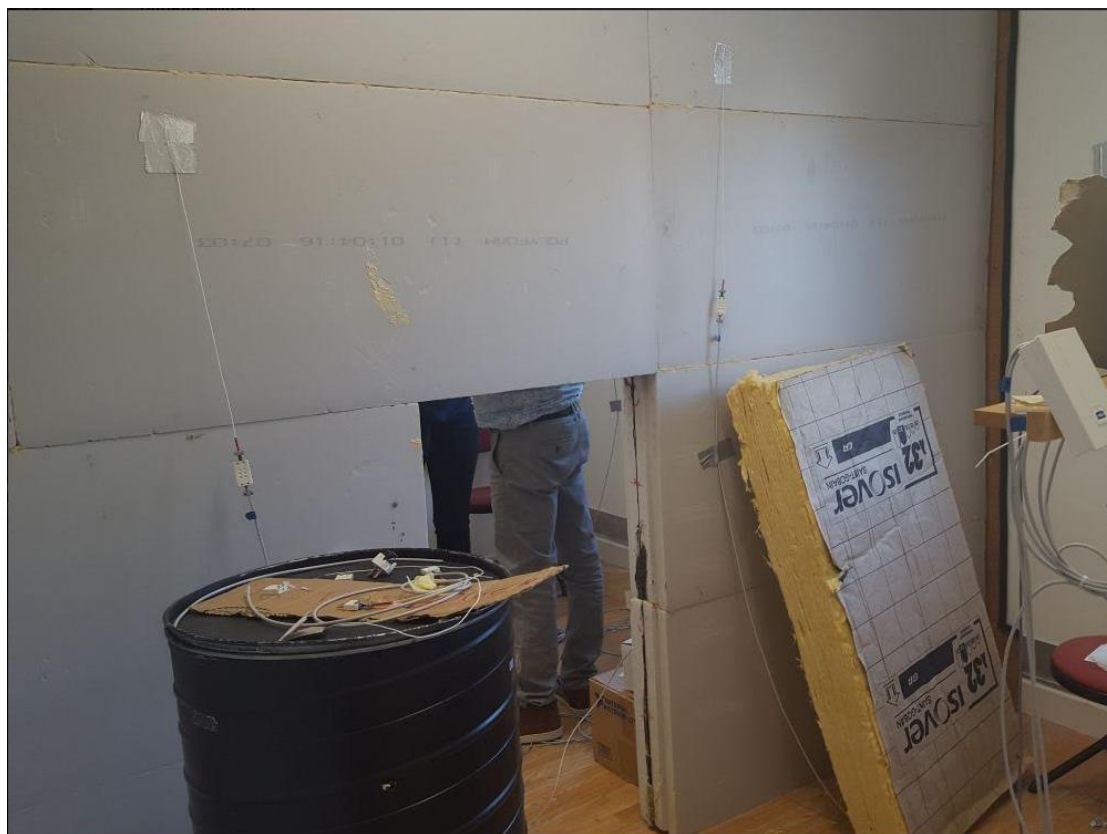
Figure III-54 : mur de séparation en polystyrène extrudé
