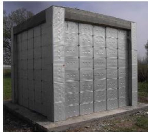
Cabine en briques perforées + polyuréthane + RT-27
