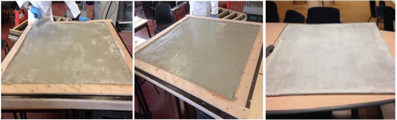
Figure III-5 : Illustration de la mise en œuvre des éprouvettes de composite textile mortier (1010 mm x 1010 mm x 10 mm)
