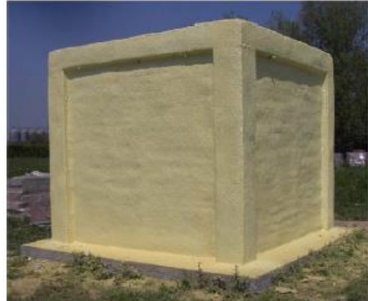
Cabine en briques perforées + isolation en polyuréthane
