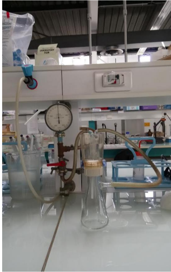
Figure III-1 : Dispositif utilisé pour filtrer le MCP
