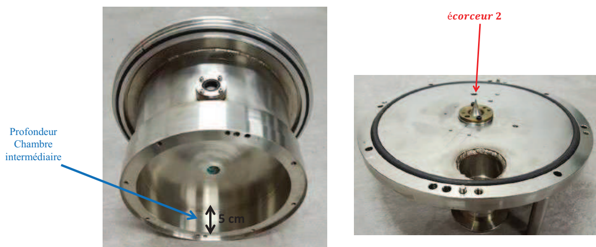
FIGURE 2.14 – Photographie permettant d’observer l’intérieur de la chambre intermédiaire. A droite, on voit la bride qui ferme le dessous de la chambre intermédiaire. L’ écorceur 2 repose sur cette bride
