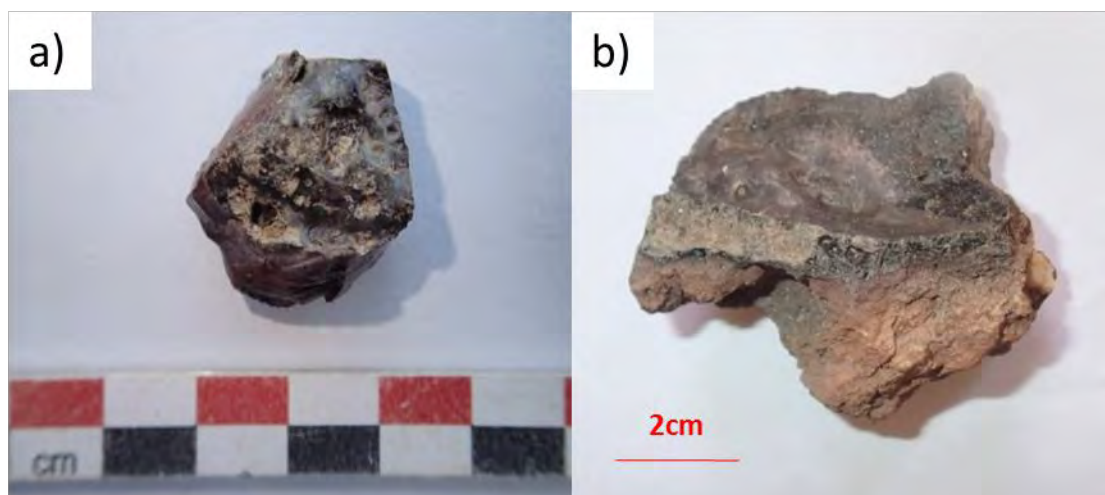
Figure VI-8 : Exemples d'échantillons de scorie (a) et de paroi de four (b) collectés sur le site d'Imiter.
