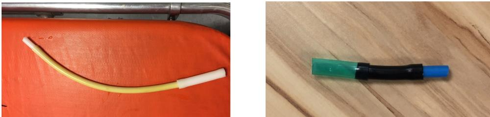
FIGURE 4.2.3 – Montage en cascade des tuyaux de faible diamètre (de l'ordre de 1 à 0,5 cm) permettant de simuler une résistance (périphérique) en aval des fantômes. A gauche : connecté au niveau des artères carotides de fantôme d'aorte ; à droite : connecté au niveau terminal du circuit des 2 fantômes.
