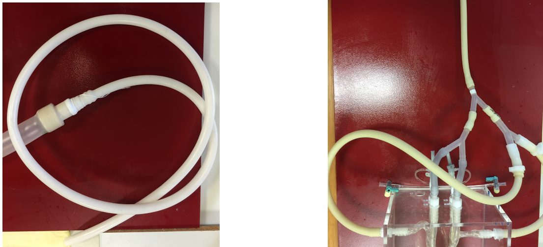
FIGURE 4.3.3 – Adaptation du banc d'essai : connexions de sortie adoptées pour le tuyau droit (côté terminal - à droite) et pour le fantôme aorte (côté de l'arche aortique - à gauche). Pour ce dernier, la sortie principale du côté de l'aorte descendante est connectée à un tuyau moins compliant que celui en sortie du tuyau droit.
