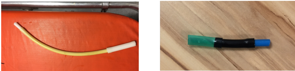
FIGURE 4.2.3 – Montage en cascade des tuyaux de faible diamètre (de l'ordre de 1 à 0,5 cm) permettant de simuler une résistance (périphérique) en aval des fantômes. A gauche : connecté au niveau des artères carotides de fantôme d'aorte ; à droite : connecté au niveau terminal du circuit des 2 fantômes.
