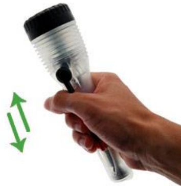
Figure 1.2 : Alimentation d'une lampe torche par conversion électromagnétique [7]
