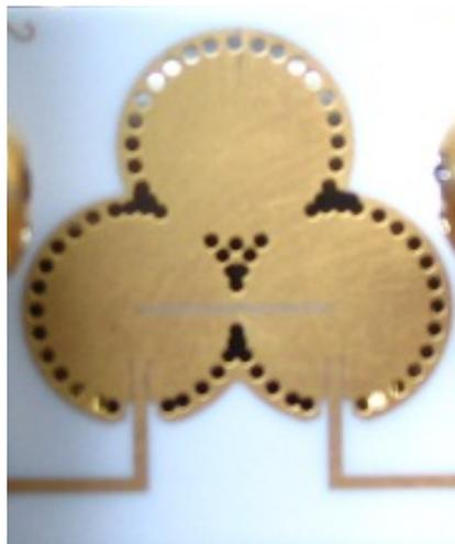
**Figure I.9: Mesure d'un circuit d'ordre 3 à couplage négatif**
