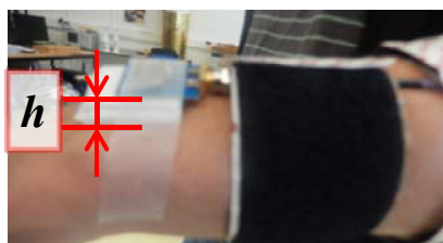
Figure 4.8 Antenne à une hauteur h au-dessus du corps en insérant des couches de diélectrique Rohacell IG31 d'épaisseur 1 mm.
