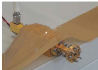
Figure 4.12 Amplificateur et guide d'onde WR15 utilisé comme émetteur pour les mesures BANs Off-body à 60 GHz.
